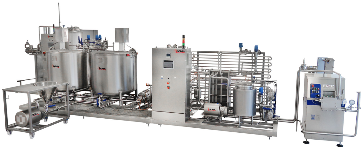
Pasteurisierer mit Mischstation und Homogenisator
